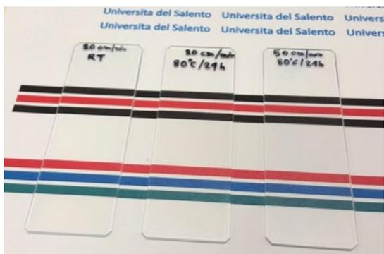
Dal punto di vista della trasparenza, i rivestimenti  $WO_3$  hanno un'ottima resa nella lunghezza d'onda visibile. Le seguenti tecniche di valutazione / caratterizzazione potrebbero essere ulteriormente spiegate per valutare a fondo il materiale e le sue proprietà.
