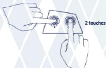
Premere contemporaneamente i tasti di "VELOCITÀ VENTOLE" e di "ACCENSIONE/SPEGNIMENTO" per 2 volte consecutive (il processo deve essere rapido). Le spie delle velocità ventole lampeggeranno 2 volte e la spia di manutenzione si spegnerà.
